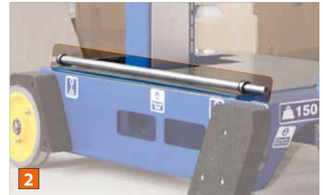
Das Notfallsenkwerkzeug befindet sich am Fahrgestell
