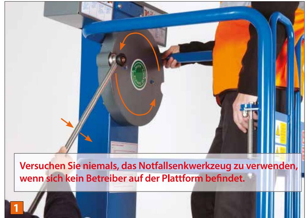
Drehen Sie das Rad **gegen den Uhrzeigersinn**, um die Plattform zu senken
