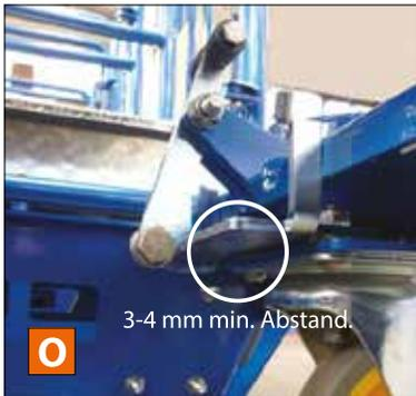
6. Stellen Sie sicher, dass sich die Plattformtüren frei öffnen und schließen, sowie dass sie sich selbst schließen, sobald sie losgelassen werden. Prüfen Sie die Drehgelenke und Federn auf Anzeichen von Materialermüdung und Beschädigungen.
