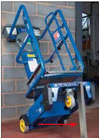
Verwenden Sie eine Sicherheitsstütze mit 660 mm Länge und platzieren Sie diese unter der Ecke des Fahrgestells bei einer der hinteren Gummiunterlagen, damit das Gerät nicht zurückkippt; der rote Pfeil zeigt die Platzierung.
