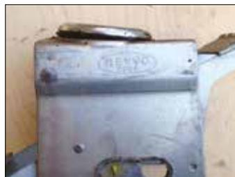
Verformung der oberen Befestigungsplatte aufgrund eines einzigen heftigen Aufpralls oder mehrerer weniger heftiger Aufprälle. Selbst wenn sich die Laufrolle ansonsten in gutem Zustand befindet, muss sie ersetzt werden.
