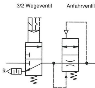
Belüftung der Anlage über Drosselstellung des Anfahrventils.
