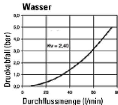
**Unverwechselbare Schnellverschlusskupplung NW 7,8**
