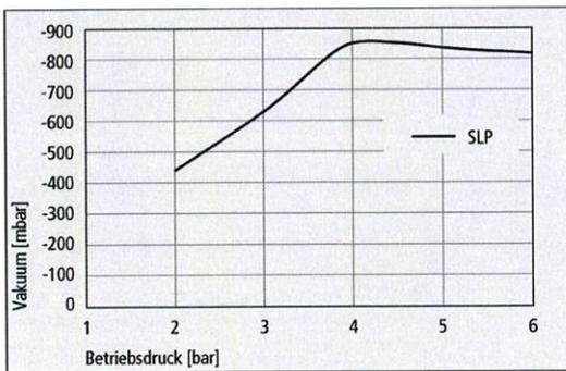
Erreichbares Vakuum bei unterschiedlichem Betriebsdruck
