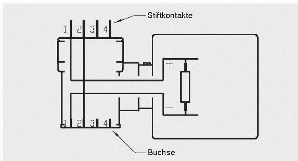
Hat der anzuschließende Transmitter den negativen Versorgungsanschluss nicht auf Kontakt 2 und den positiven Versorgungsanschluss nicht auf Kontakt 1, so muss die Belegung des Winkelsteckers der A-AI-1 und des externen Winkelsteckers dementsprechend angepasst werden. Hierzu den Winkelstecker der A-AI-1 öffnen und die Drähte von Kontakt 1 und Kontakt 2 so austauschen, dass diese dem Anschluss des anzuschließenden Transmitters entsprechen.
