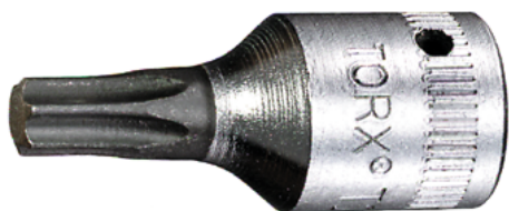
01350010 44 KTX T 10 SCHRAUBENDREHEREINSATZ 1/4 ZOLL 6,3 mm (1/4") Schraubendrehereinsatz TORX T10 L.28 mm
