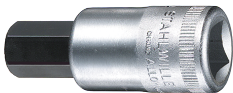
03050004 54 4 12,5 mm (1/2") INHEX-Einsatz 4 mm L.60 mm
