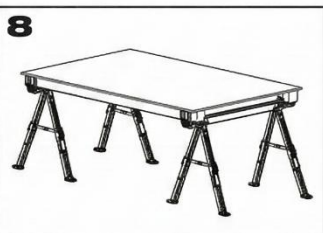
In Kombination mit einem zweiten Sägebock können Sie einen Arbeitstisch erstellen, der bis zu 1180 kg tragen kann. Sie müssen nur Balken zwischen die Seitenhalterungen einlegen und die 2 Sägeböcke verbinden.
