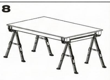
In combinazione con un secondo cavalletto, è possibile creare un tavolo da lavoro in grado di sopportare fino a 1180 kg. È sufficiente inserire travi tra i supporti laterali e collegare i 2 cavalletti.
