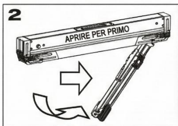
Sopra l'indicazione 'APRIRE PER PRIMO', premere il pulsante di rilascio e tirare giù le gambe fino a quando non sono completamente estese.
