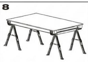
Klap de steunpennen uit om een plaat te ondersteunen voor het zagen.
