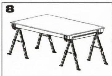
W połączeniu z drugim koziołkiem można stworzyć stół roboczy o udźwigu do 1180 kg. Wystarczy włożyć belki między wsporniki boczne i połączyć 2 koziołki.
