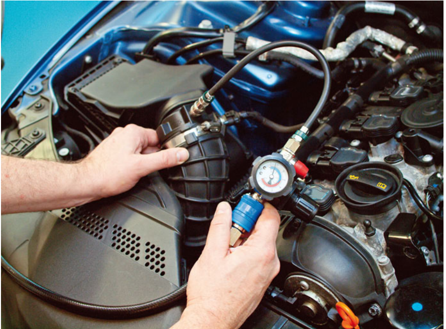
Das Beispiel zeigt das Werkzeug beim Testen einer Ladeluftkühler Windung eines Turbo Systems
