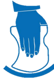
Auftragen und Glätten bei einem Rohrbogen
