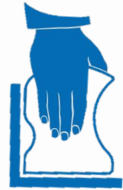
Abziehen und Glätten einer Anschlussfuge
