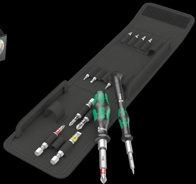
Im Wera Osterei enthalten ist ein Set mit Schraubwerkzeugen für 13 unterschiedliche Profile im Micro- und im Werkstattbereich. Das Micro-Sortiment beinhaltet neben dem Handhalter mit drehbarer Kappe je 2 Micro-Bits Kreuzschlitz PH, Schlitz, TORX® und Innensechskant. Das Werkstatt-Sortiment besteht aus einem Bit-Handhalter im ergonomischen Kraftform Design und je 2 Kreuzschlitz-Bits PH und PZ sowie 1 Schlitz-Bit.
